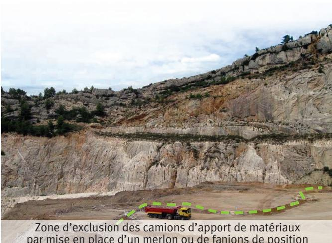
Zone d'exclusion des camions d'apport de matériaux par mise en place d'un merlon ou de fanions de position
