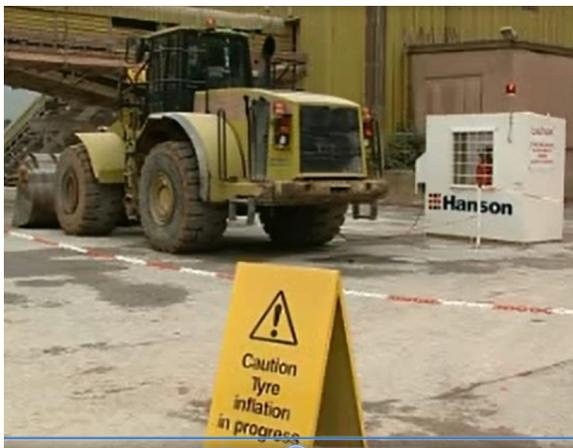
Mise en place d'une **signalisation adaptée et balisage** durant les phases de gonflage des pneumatiques.
