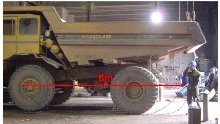
La mise en pression du pneumatique se fait à l'aide d'un manomètre muni d'un tuyau de 6m permettant à l'opérateur de se positionner **à 6m du pneu dans l'axe de la bande roulement.**
